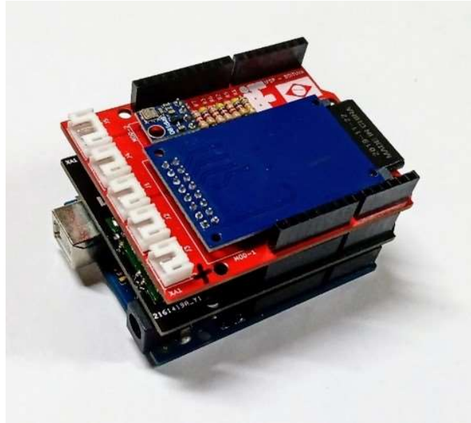
Figura 2 – Placa de circuito impresso de acondicionamento dos sensores
