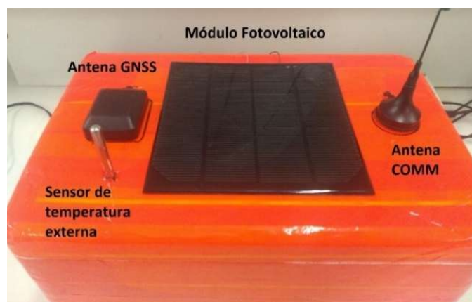
Figura 4 – Vista externa superior da sonda
