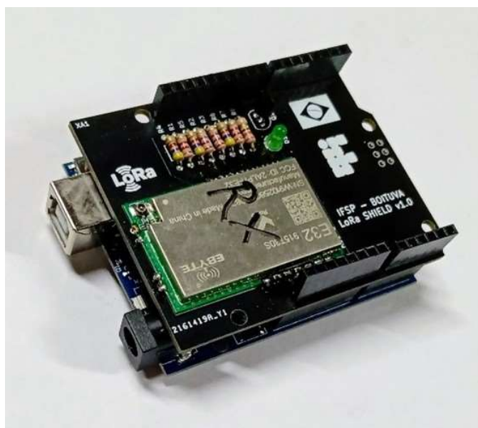
Figura 1 – Sistema de comunicação desenvolvido para a PMM
