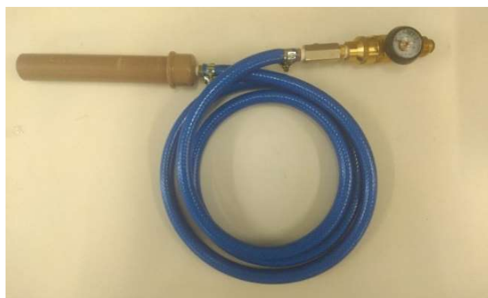
Figura 8 – Sistema de enchimento do balão
