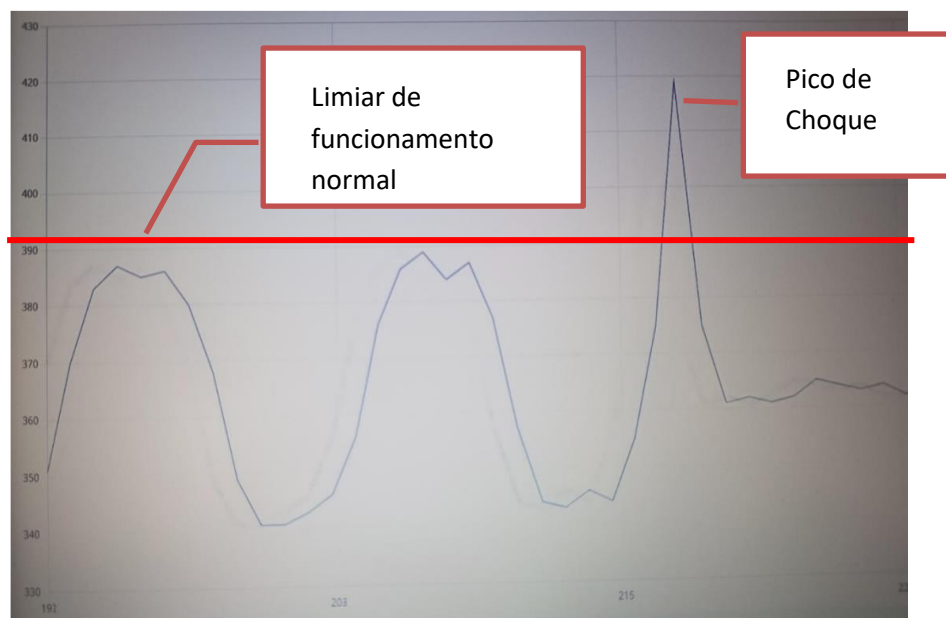
Figura 8 - Curva do pico - demonstração da fuga de corrente.
